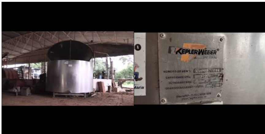
TANQUE KEPLER WEBER CAPACIDADE 3.000 LITROS
