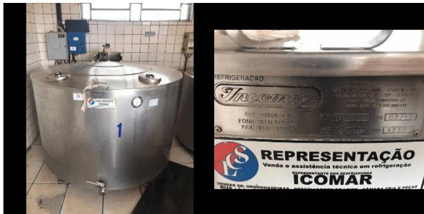
TANQUE DE REFRIGERAÇÃO MARCA ICOMAR TRIFÁSICO CAPACIDADE 2000 LT ANO 1999
