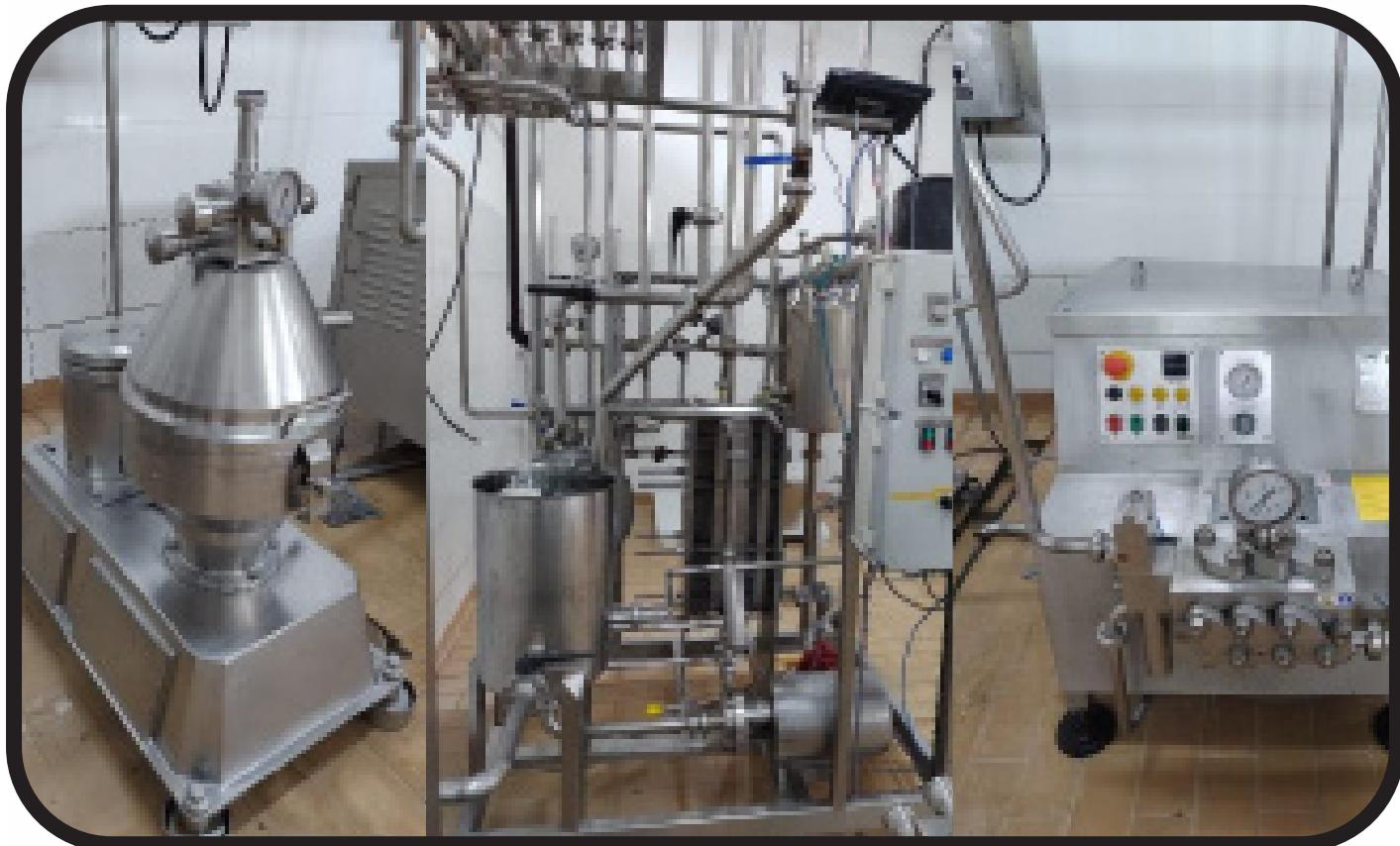
**Linha de Pasteurização e Padronização de Leite (sistema HTST / pasteurizador de placas com homogeneizador e desnatadeira), com painel elétrico.**
