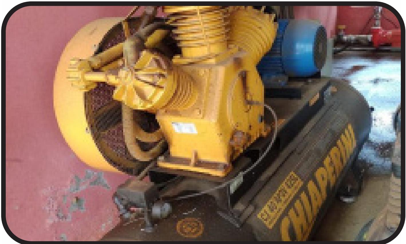
O equipamento da foto é um Compressor de Ar CHIAPERINI – Modelo CJ 40 APV 425L, um modelo industrial de pistão amplamente usado em laticínios, oficinas, serralherias e indústrias em geral, responsável por fornecer ar comprimido para acionamento de válvulas, pistões pneumáticos e outros sistemas automatizados
