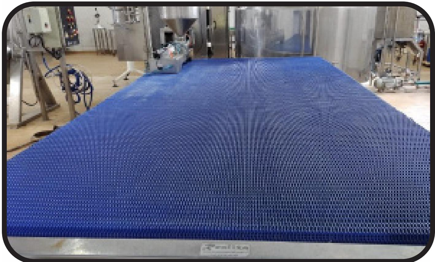
**Esteira Transportadora Inox com Correia Modular Comprimento
