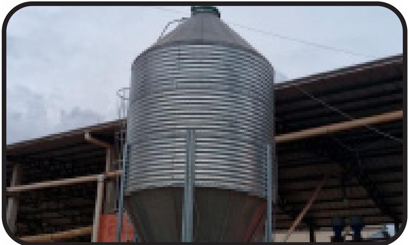
Silo metálico vertical com estrutura em aço galvanizado, projetado para armazenamento seguro e eficiente de grãos e rações. Possui formato cônico inferior para facilitar o escoamento do material e acesso rápido para carregamento e descarga. Suporta exposição às condições externas, garantindo durabilidade e resistência
