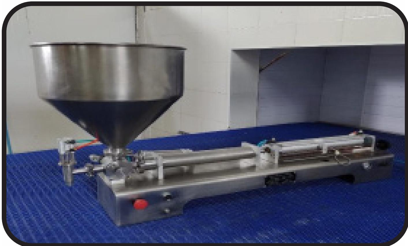
**Dosadora Volumétrica Pneumática de Bancada em Aço Inox
