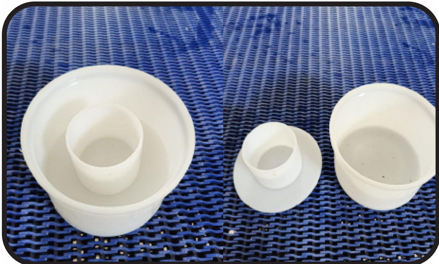
O item mostrado na imagem é uma fôrma plástica cilíndrica para queijo tipo Ricota, acompanhada de seu dessorador interno (também chamado de miolo ou núcleo de drenagem). Esse conjunto é usado especificamente para dar o formato característico e permitir a drenagem controlada do soro durante a fabricação da ricota
