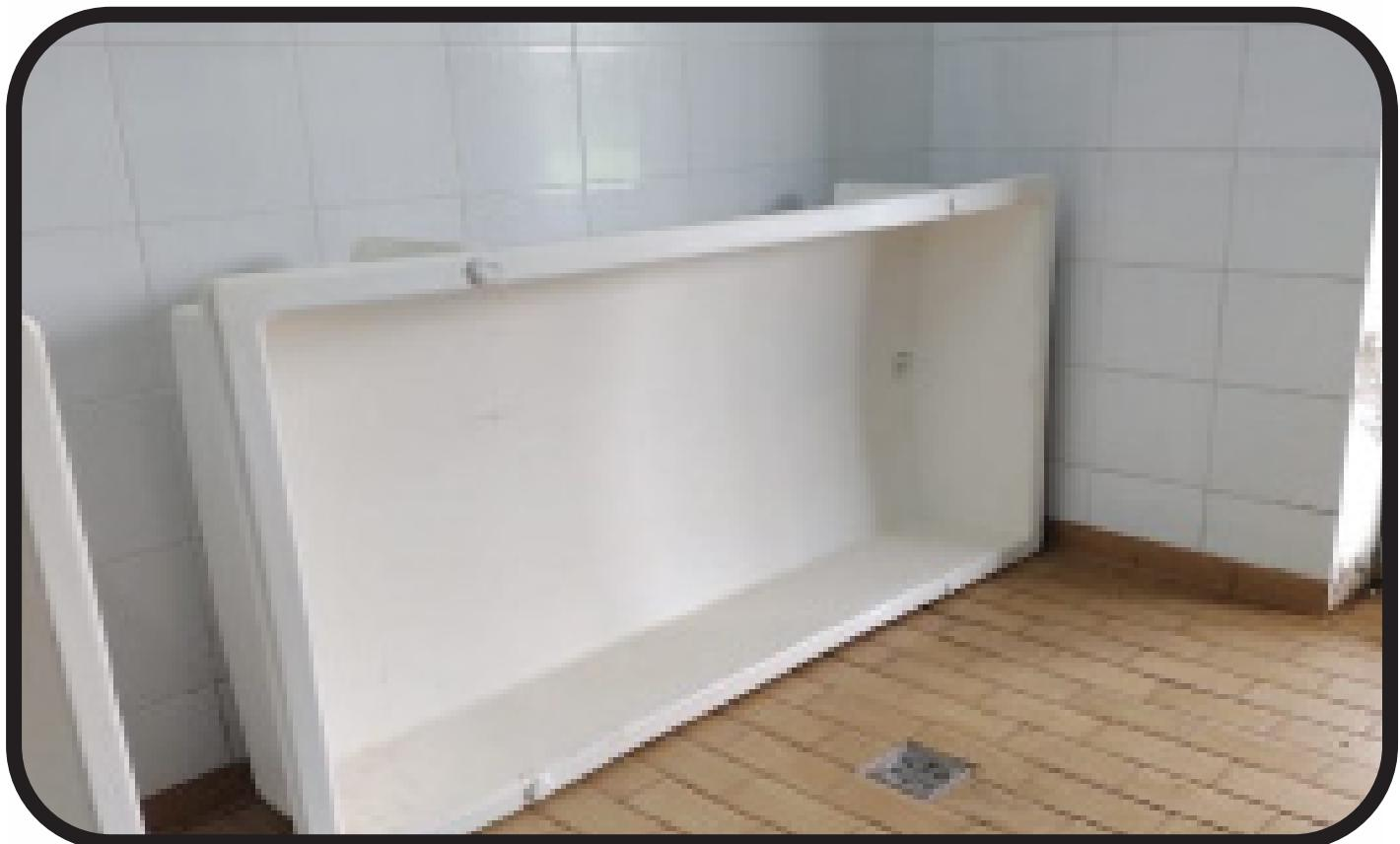
O tanque para salga é utilizado na imergem de queijos em solução salina (salmoura), etapa fundamental no processo de fabricação de queijos como Minas, Prato, Mussarela e Parmesão. A fibra de vidro garante alta durabilidade, isolamento térmico e resistência química, evitando corrosão mesmo em contato prolongado com o sal.
