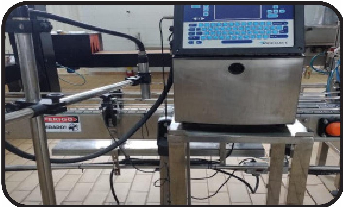
O equipamento mostrado na imagem é uma Impressora Industrial por Jato de Tinta Contínuo (CIJ), marca Videojet, modelo típico das séries 1210 / 1510 / 1610. Essas impressoras são amplamente utilizadas em linhas de envase e embalagem para realizar marcação de data de validade, lote, código de produção, logotipos e informações variáveis diretamente nas embalagens
