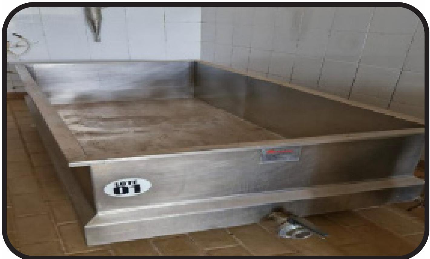
tanque de aço inoxidável, processamento ou armazenamento
