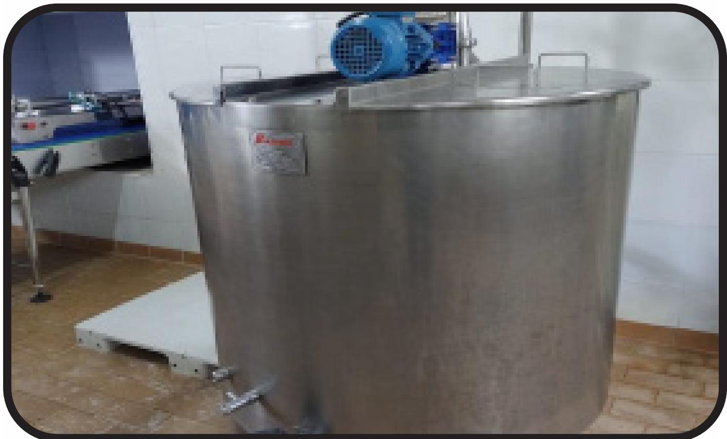
O equipamento mostrado na imagem é um Tanque de Processo com Agitador (ou Tanque de Mistura em Aço Inoxidável) – muito utilizado em laticínios, indústrias alimentícias e farmacêuticas para mistura, homogeneização e aquecimento de produtos líquidos, como leite, iogurte, caldas e outros derivados. O modelo da foto é da marca Biasinox, fabricante reconhecida no setor de equipamentos para alimentos e bebidas.
