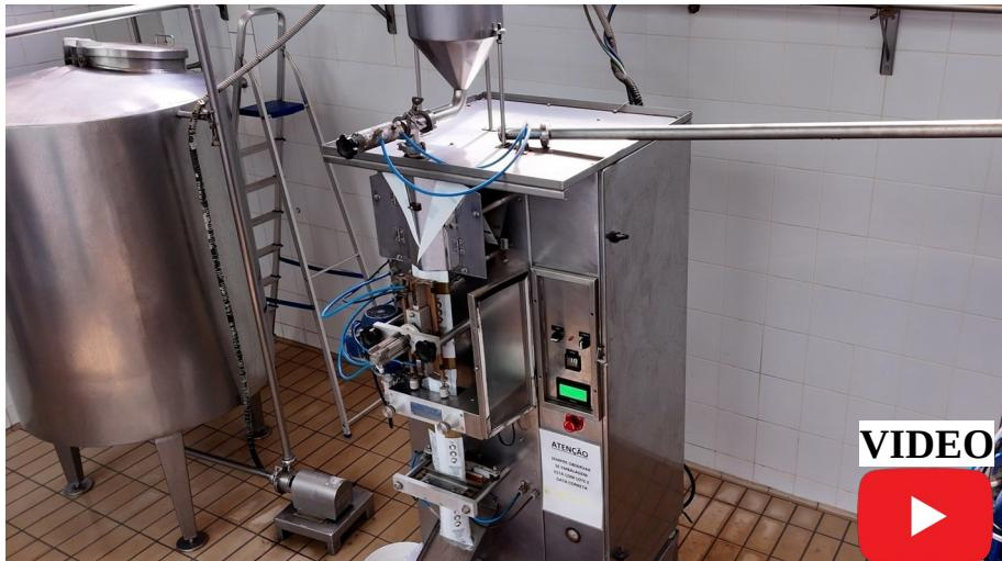
TIPO: CONJUNTO DE ENVASE AUTOMÁTICO PARA LEITE (SISTEMA VERTICAL "FORM-FILL-SEAL" – FFS).
