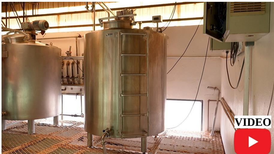
**TIPO:** TANQUE DE PROCESSO VERTICAL (MISTURADOR).
