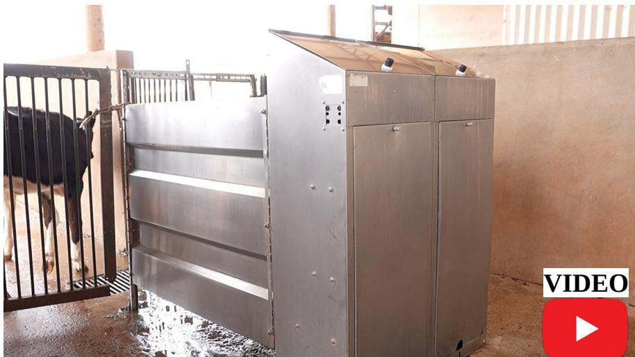
*TIPO: ALIMENTADOR AUTOMÁTICO DE BEZERRAS (AMAMENTADOR).*
